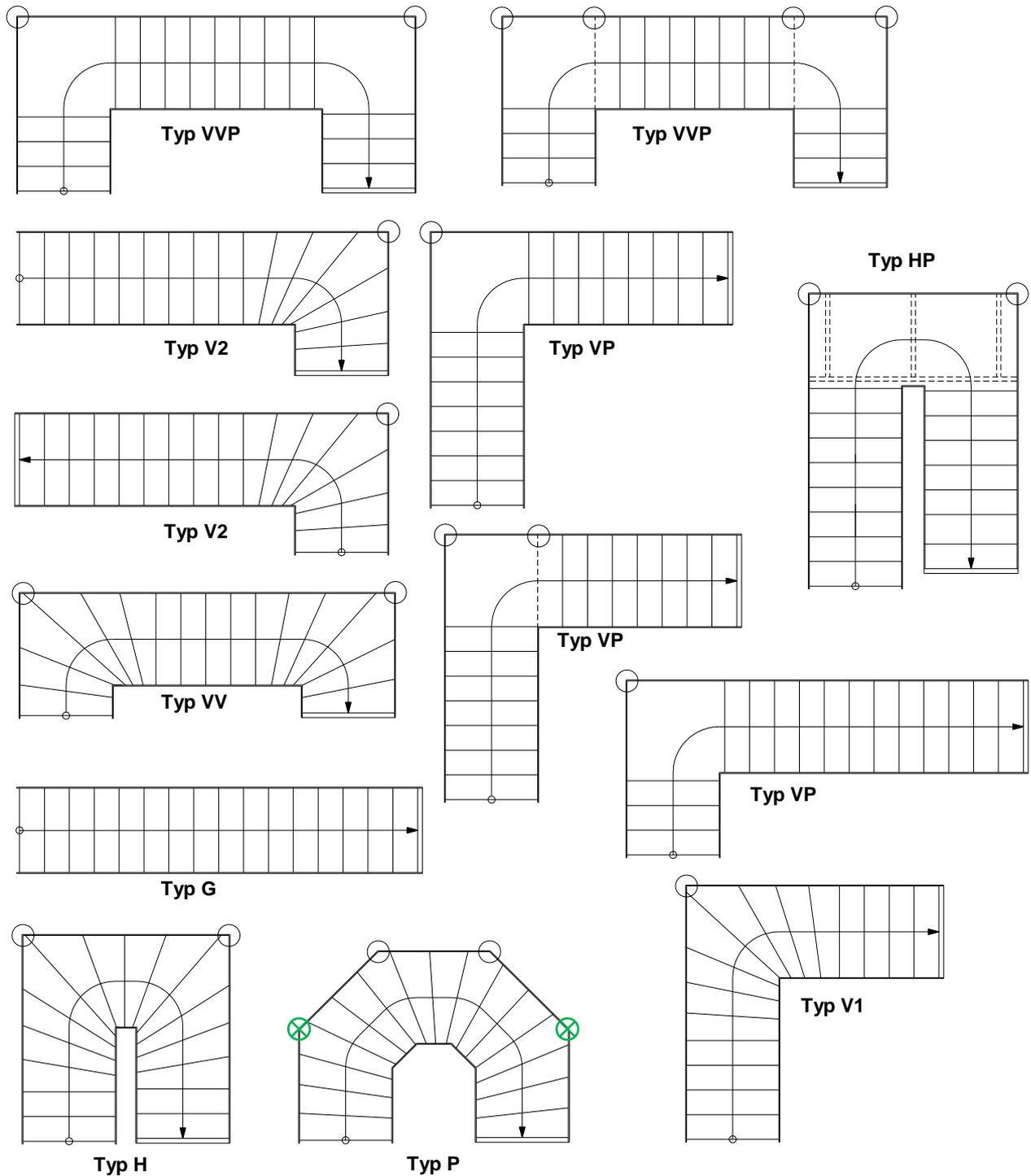
○ Auflager für Vertikallasten, horizontale Wandanbindung entsprechend technischer Dokumentation
